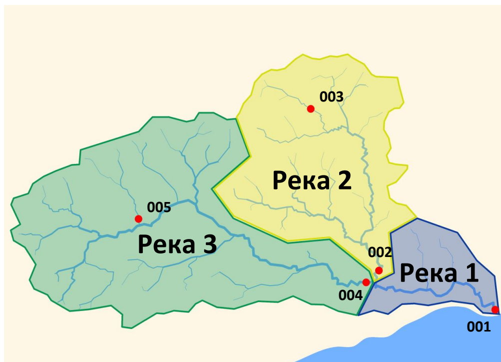
Рисунок 5.2. Подразделение речного бассейна из примера на рисунке 5.1 на три водных объекта
